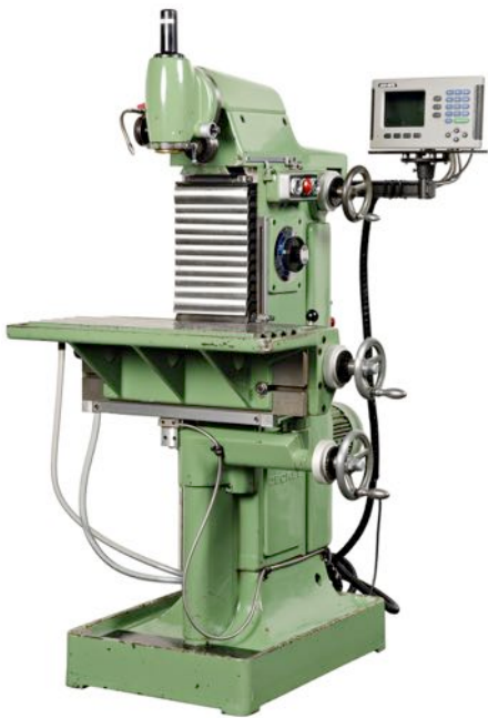
Universal Werkzeugfräsmaschine DECKEL FP 1 – Lager-Nr. L6401 (W)
