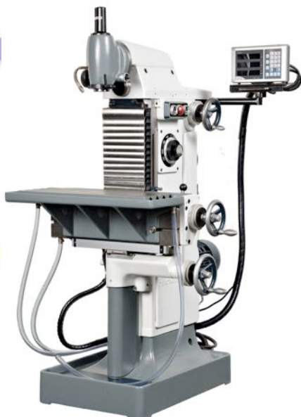
Universal Werkzeugfräsmaschine DECKEL FP 1 – Lager-Nr. L5824 (Ü)
