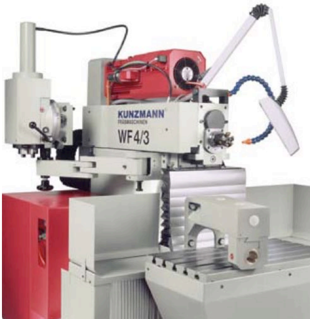
Horizontale Bearbeitung mit oder ohne Gegenhalter
