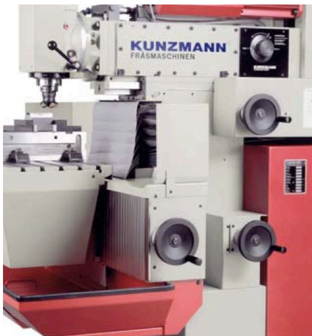
Ergonomisch angeordnete Sicherheitshandräder zum manuellen Verfahren
