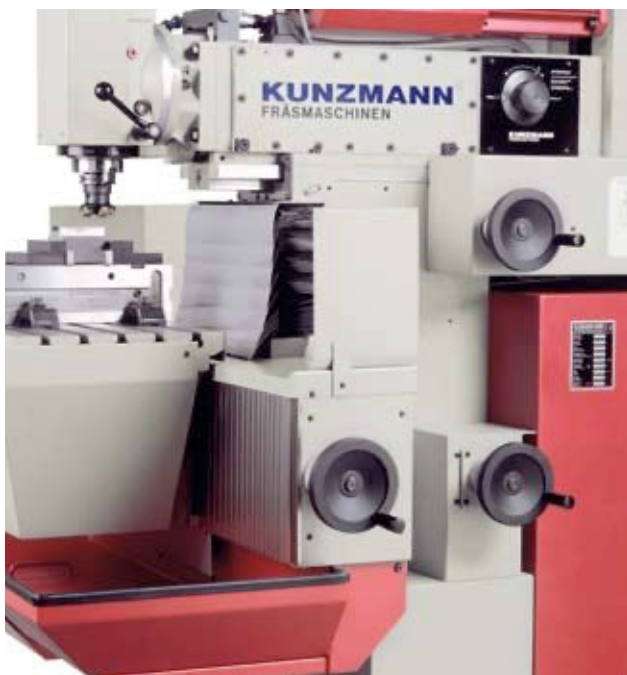
Ergonomisch angeordnete Sicherheitshandräder zum manuellen Verfahren
