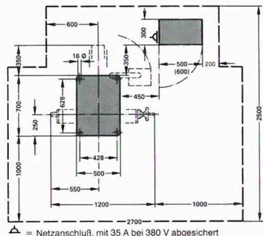
△ = Netzanschluß, mit 35 A bei 380 V abgesichert
