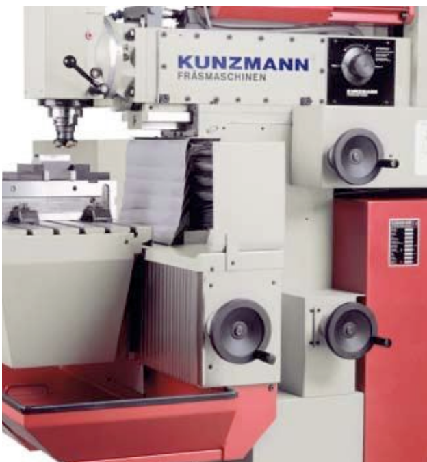
Ergonomisch angeordnete Sicherheitshandräder zum manuellen Verfahren
